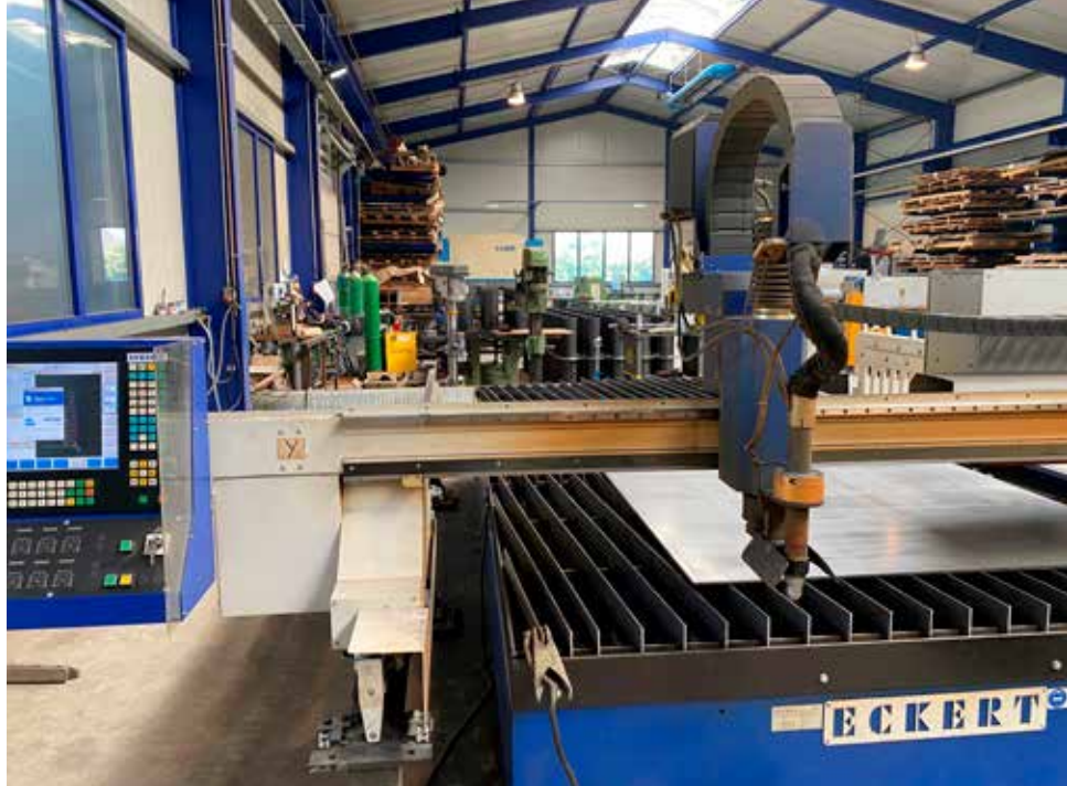
Der Plasmaschneider bei G-L Metallbau lässt sich sowohl über einen an der Anlage befindlichen Bildschirm bedienen als auch via CNC über PCs im Büro steuern.
